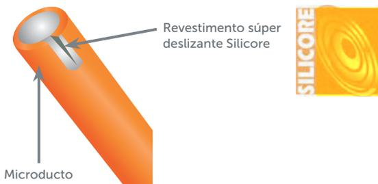
Con nuestro revestimiento súper deslizante Silicore se garantiza que haya una disminución de la fricción entre el cable y el ducto incluso cuando se presentan curvas (ver figura a continuación). Esto permite una mayor distancia entre cámaras y disminuyen los esfuerzos mecánicos sobre el cable.
